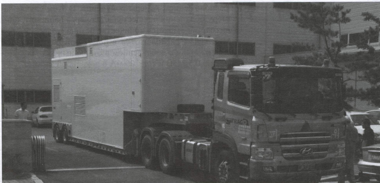
Рис.8. Передвижной ускоритель в процессе транспортировки
