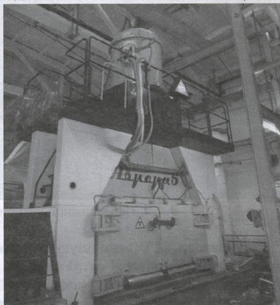
Рис.6 Схематический чертеж и вид ускорителя 0.5 МэВ*100 мА в локальной защите
